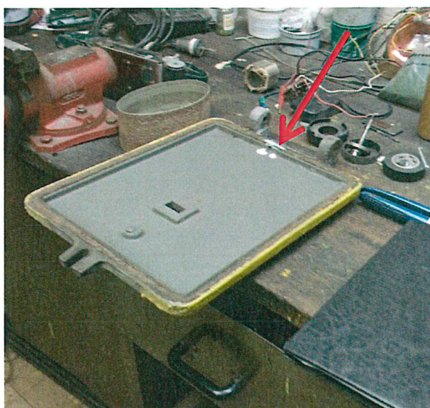
Foto č. 5 - Lokalizace místa odběru vzorku č. 2 . Technická budova SSZT, 1.NP, dílna údržby. Azbestová těsnicí šňůra v přírubě dvířek elektrorozvodné krabice návěstidla.
